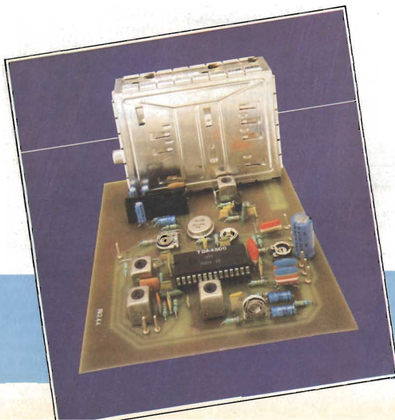
Fig. 2 - Prototipo di laboratorio nel quale tutte le funzioni interessate all'elaborazione dei segnali audio e video di un televisore in bianco e nero (partendo dal tuner fino agli stadi di potenza audio, video, finali di riga e di quadro) sono contenute nell'integrato TDA4500.
