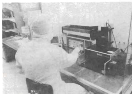
Scanner a laser per rilevare eventuali difetti nel wafer.
